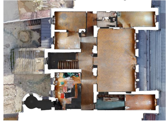
Figure 15 Kład na płaszczyznę podłogi kondygnacji parteru w technologii MATTERPORT
