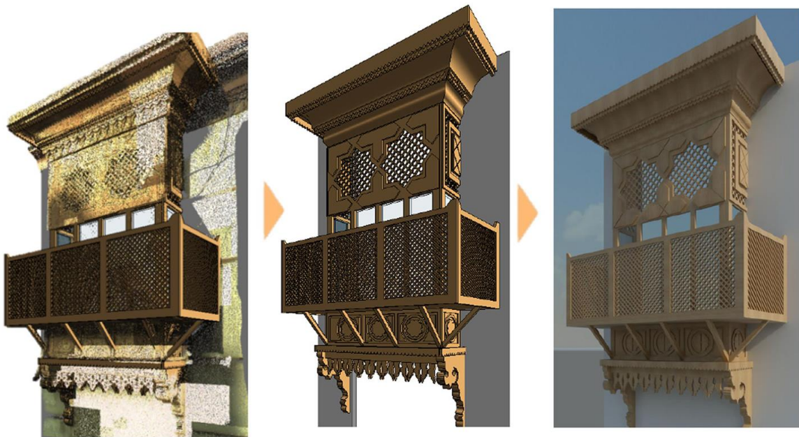
Proces parametryzacji surowych chmur punktów do technologii BIM [7]
